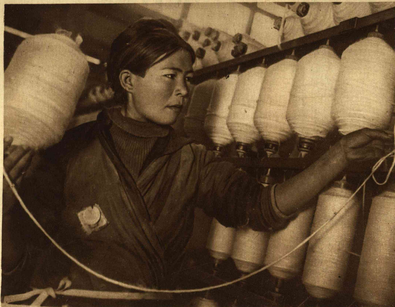
Работница-узбечка т. Ахрарова у банкаброшной машины
